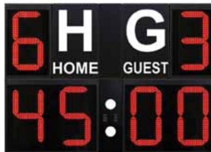
art. 8461 Tabellone elettronico per esterno con visualizzazione per punteggio (da 0 a 9) e del tempo di gioco. Ogni cifra è alta 45 cm ed è composta da 264 led ad alta visibilità. Quando la console è spenta o scollegata viene visualizzata automaticamente l'ora del giorno. Resistente agli urti, a norma DIN 18032-3 e UNI 9554, 166,5x118x15 cm
