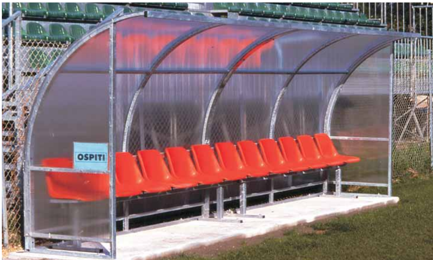
art. 6234 Panchina struttura in acciaio zincato a caldo, ricoperta in policarbonato alveolato, sp. mm 4, profilato mm 50x30, sedute a scocche in polipropilene (mod. Curvo) mt 6, 12 posti
