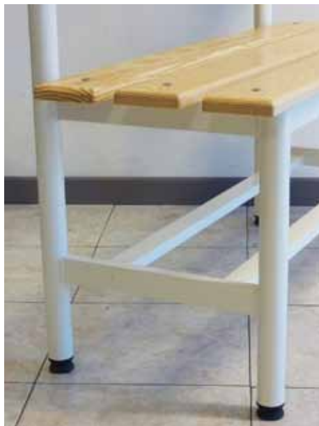
Panca spogliatoio in alluminio con montanti in tubo rotondo e traversi in tubo rettangolare, doghe in legno verniciato al naturale, piedini antiscivolo regolabili
