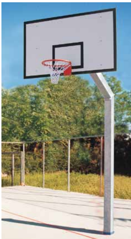
art. 4201 Impianto monotubo con tabelloni in resina melaminica sbalzo 165 cm struttura smontabile con piastre di collegamento Outdoor basketball system, posts hot galvanized, laminated backboard arm 165 cm
