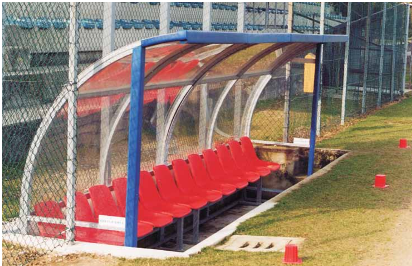
art. 6254 Panchina struttura in profilato di lega d'alluminio rivestita in policarbonato trasparente sp. mm 3, profilato mm 50x30, sedute a scocche in polipropilene (mod.curvo) mt 6, 12 posti
